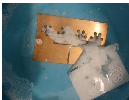
Рисунок 4. Отмывка схемы антенной решетки после применения ЛУТ
