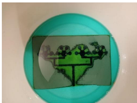
Рисунок 6. Травление платы антенной решетки в растворе перекиси водорода, лимонной кислоты и соли
