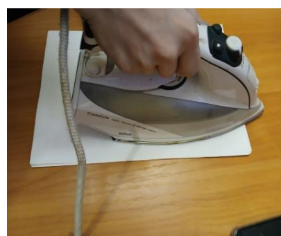
Рисунок 3. Перенос напечатанной схемы антенны на текстолит утюгом (ЛУТ)
