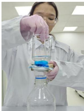
Рисунок 13. Тест мембраны на супергидрофобность
