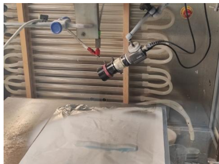
Рисунок 4. Процесс формирования мембраны
