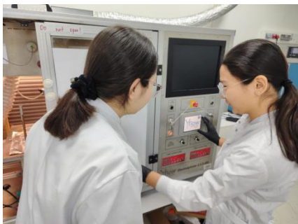
Рисунок 3. Работа с аппаратом электроспиннинг
