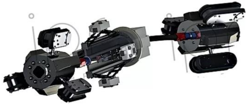
Рисунок 2. Робот для внутритрубной диагностики (позволяет вести анализ в нефтепроводе при наличии нефти), In-Pipe Robot, РФ
