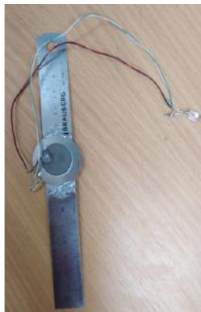
Рисунок 2. Пьезопластинка, питающая светодиод
