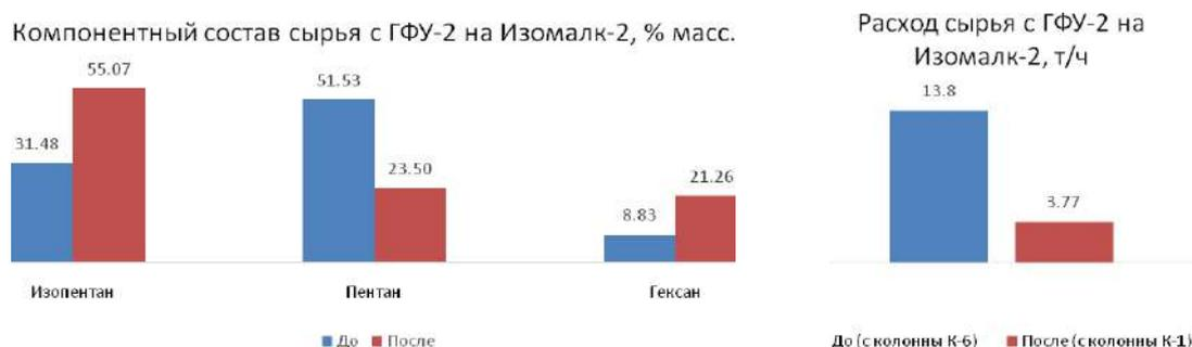
Рис. 3. Сравнение сырьевых потоков с ГФУ-2 на Изомалк-2
