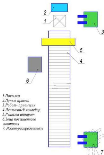
Рис. 1. Схема автоматизированного участка приема посылок на почтовом отделении
