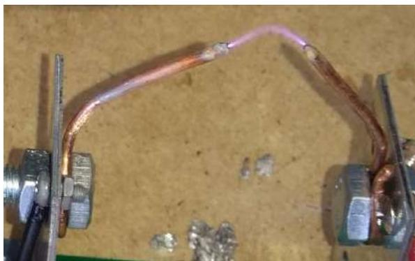
Рис. 3. Электрическая дуга Ионифона
