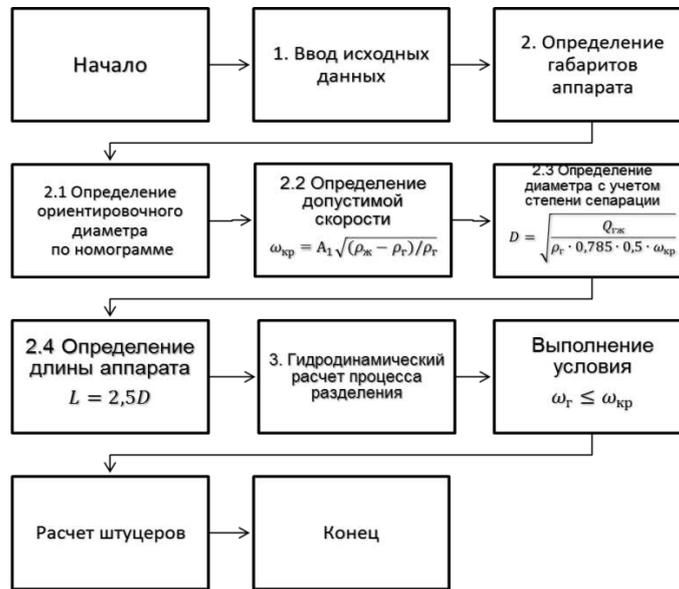
Рис. 1. Алгоритм расчета факельного сепаратора
