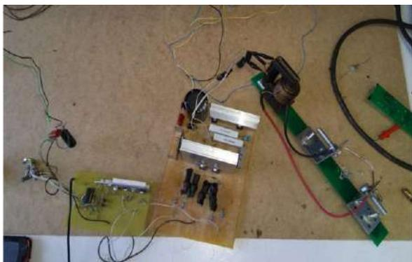
Рис. 2. Двухтактный высоковольтный преобразователь на TL494 (Ионофон)
