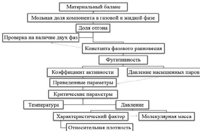
Рис. 1. Алгоритм расчета материального баланса процесса сепарации
