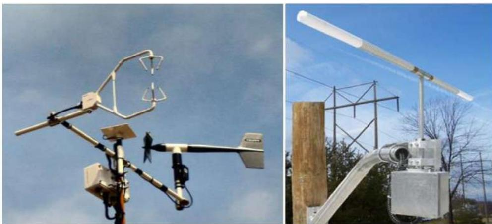
Рис. 1. Традиционные пропеллерные и ультразвуковые анемометры [слева] и направленный анемометр модели проводника [справа]
