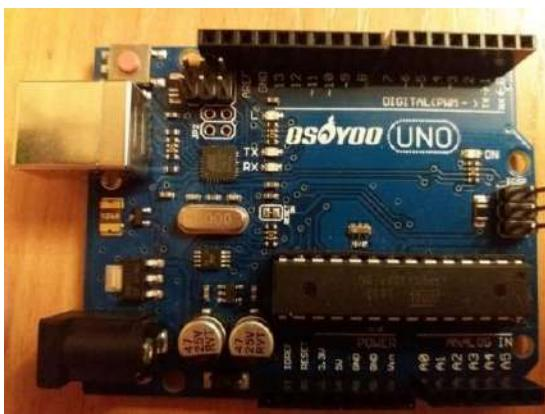
Рис. 1. Плата Arduino UNO
