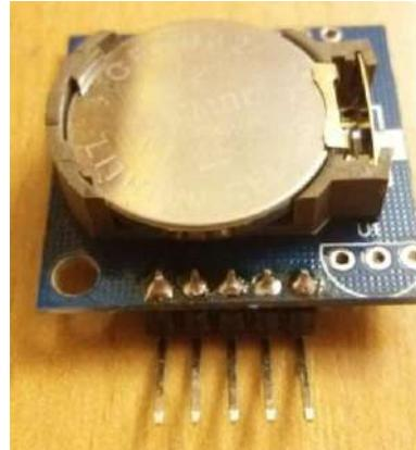
Рис. 2. Модуль часов реального времени
