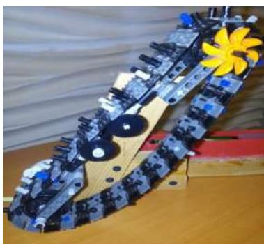
Рис. 1. Ленточный пластинчатый конвейер
