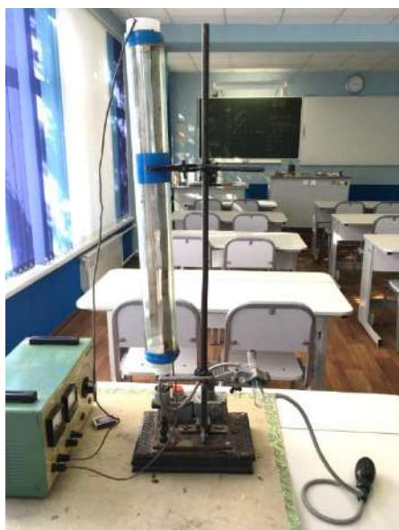
Рис. 3. Установка для исследования коронного разряда
