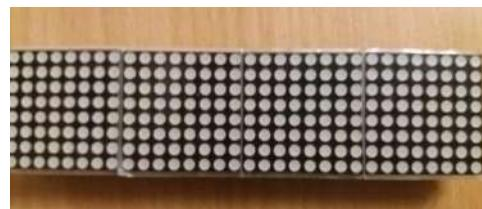
Рис. 4. MAX7219 из четырех частей стандартного размера
