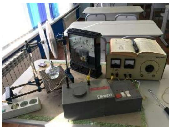
Рис. 1. Исследовательская установка для изучения ионизирования газов
