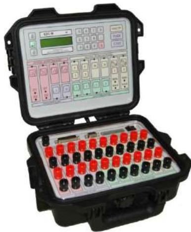
Рис. 1. Внешний вид калибратора КЭС-М
