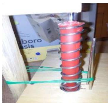
Рис. 2. Винтовой вертикальный конвейер
