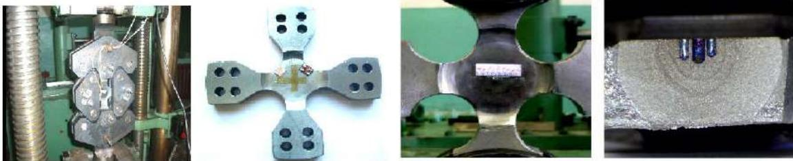
Рис. 2. Проведение усталостных испытаний крестообразных образцов
