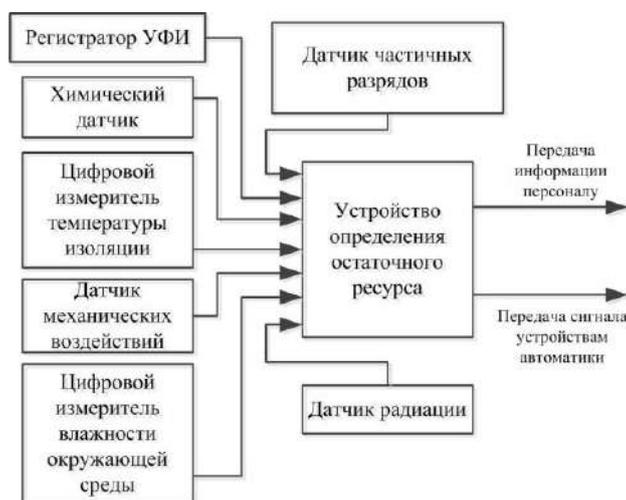
Рис. 1. Структурная схема прогнозирующей защиты
