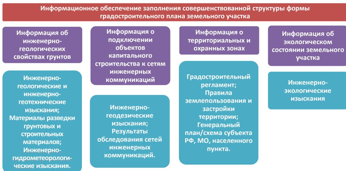
Рис. 4. Технологическая схема информационного обеспечения заполнения совершенствованной структуры формы ПЗУ
