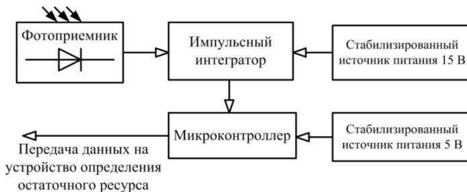
Рис. 2. Структурная схема регистратора УФИ
