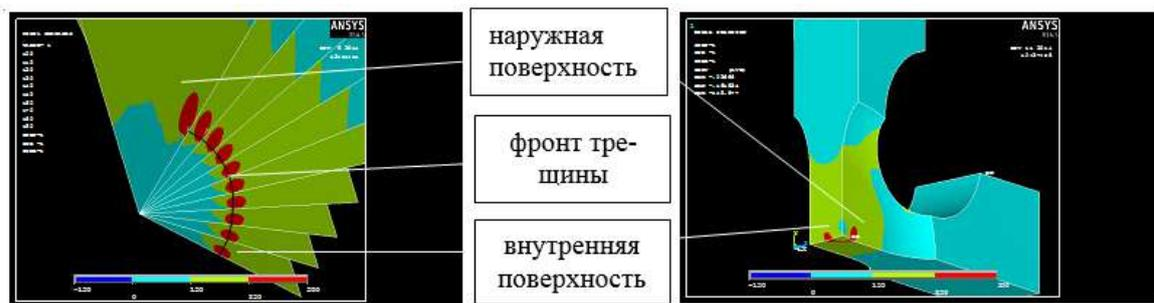
Рис. 4. Рассечение исследуемого образца плоскостями
