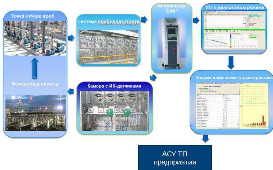
Рис. 3. Схема онлайн-анализа при установке многопоточного анализатора
