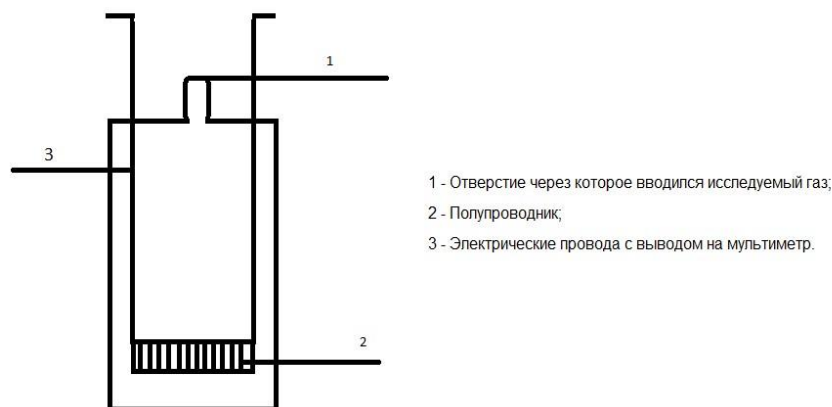
Рисунок 1. Модель газового сенсора
