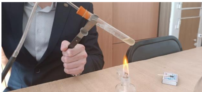
Рисунок 4. Нагрев смеси и конденсация пара в газоотводной трубке
