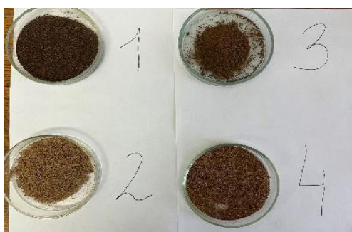
Рисунок 1. Сорбент из скорлупы кедровых орехов (1), сорбент из скорлупы фисташек (2), сорбент из скорлупы грецких орехов (3), субстрат кокоса (4).
